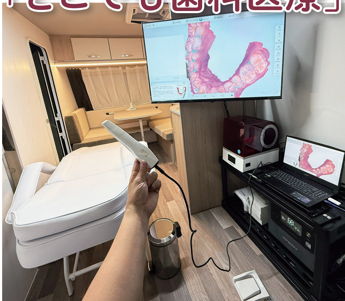
トレーラーの中に、口腔内スキャナーとAI設計アプリ、3Dプリンターを搭載！
