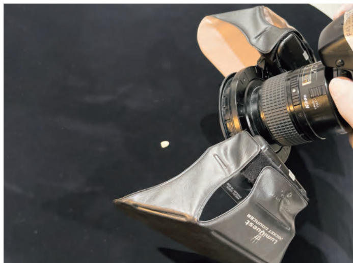
図 14 補綴装置は黒ベルベットの上に置き，レンズ両サイドに設置したフラッシュ（Nikon リモートスピードライト SB-R200）にバウンサーを装着して撮影．
