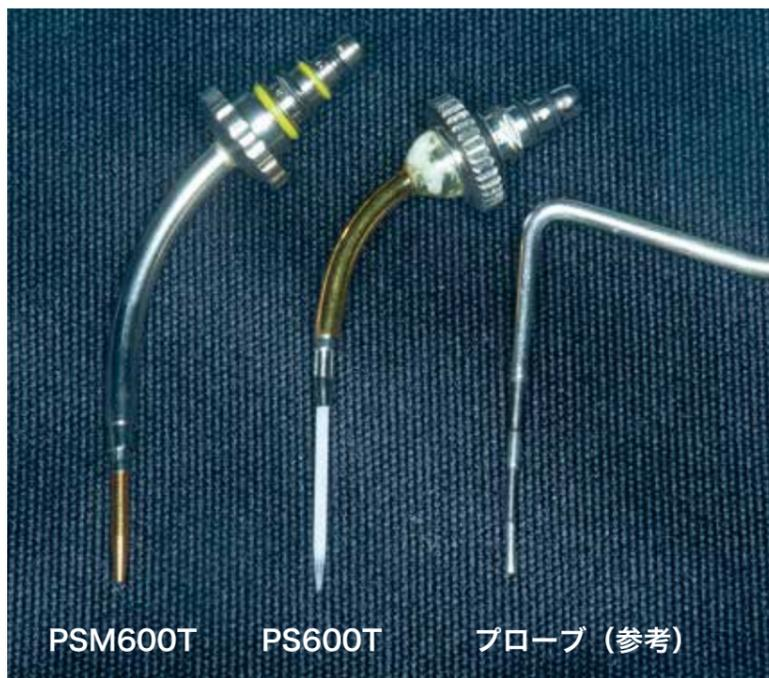
図 2-1 ■筆者が主に使用しているレーザーチップ2種とプローブ（参考）。チップの先端はプローブの太さよりやや太い程度なので、プローブの挿入できる部位であればほとんど挿入することができる。ただし先端が石英でできているチップ（PS600Tなど）は石英が軟らかいため、慎重な挿入が求められる。
