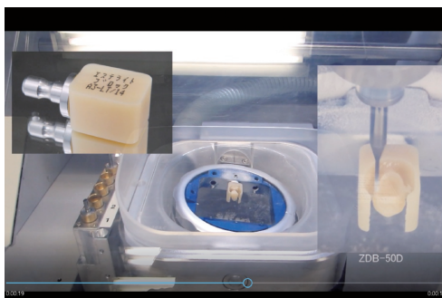
図4-13 CAMソフトウェアによるコンポジットレジンブロックの切削加工
