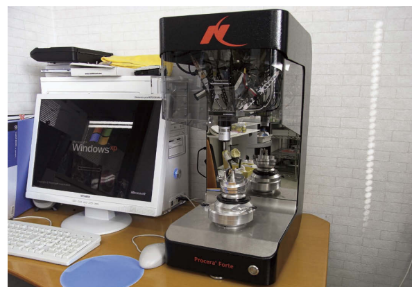
図2 プロセラフォルテスキャナー（NobelBiocare）ラボサイドでスキャンニングを行い、センターに加工を委託する方式である
