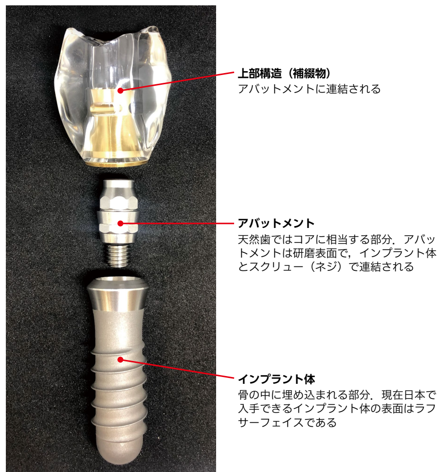
図1-1 インプラントの基本構造
