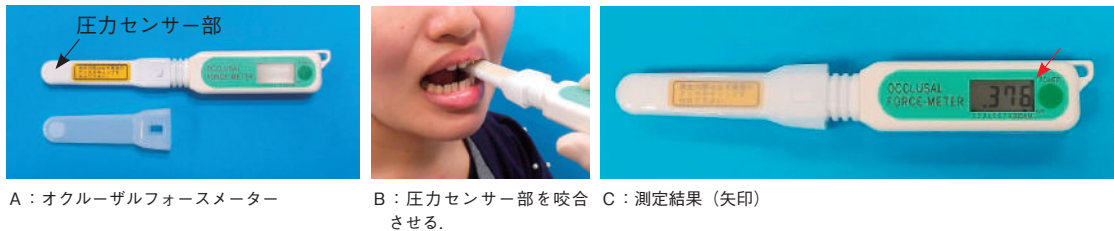
図 II-1-12 オククルーザルフォースメーターによる検査
