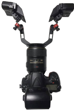
図19 Scorpionブラケットを用いて被写体の真横から光を当てる撮影法
