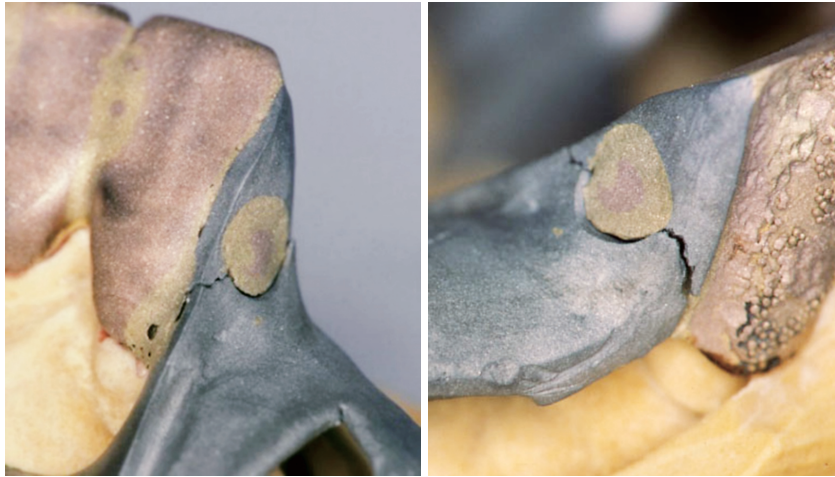
図 6-4-7 人工歯，前装部レジン，義歯床を焼却し除去を行ったところ，コーヌス外冠とフレームワークのろう着部において，フレームワークの破断が認められた
