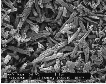
図6-II-4 加熱加圧タイプのニケイ酸リチウムガラスの微細構造 (Denry I, Holloway JA, 2010 9) より)
