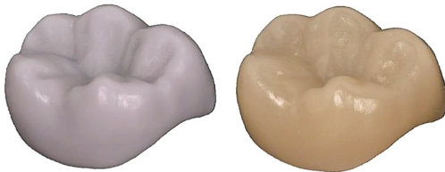
図6-II-6 CAD/CAMによって削り出したニケイ酸リチウムガラス 写真左は熱処理前、右は熱処理後。
