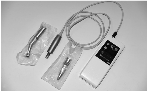
図10 ポータブルエンジンはコントラアングルヘッドがあると便利だが、とりあえず技工用エンジンでも可
