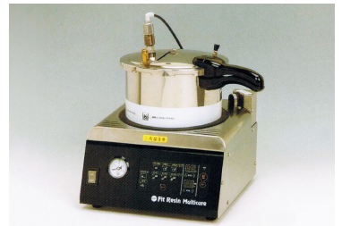
I: 加圧重合。レジン表面につやがなく膜の張ったような状態になるのを待って、注入孔を上にして十分に水を入れた加圧重合器にコアごと模型を入れ密閉し、0.2 MPa 50°C で 30 分重合する。
