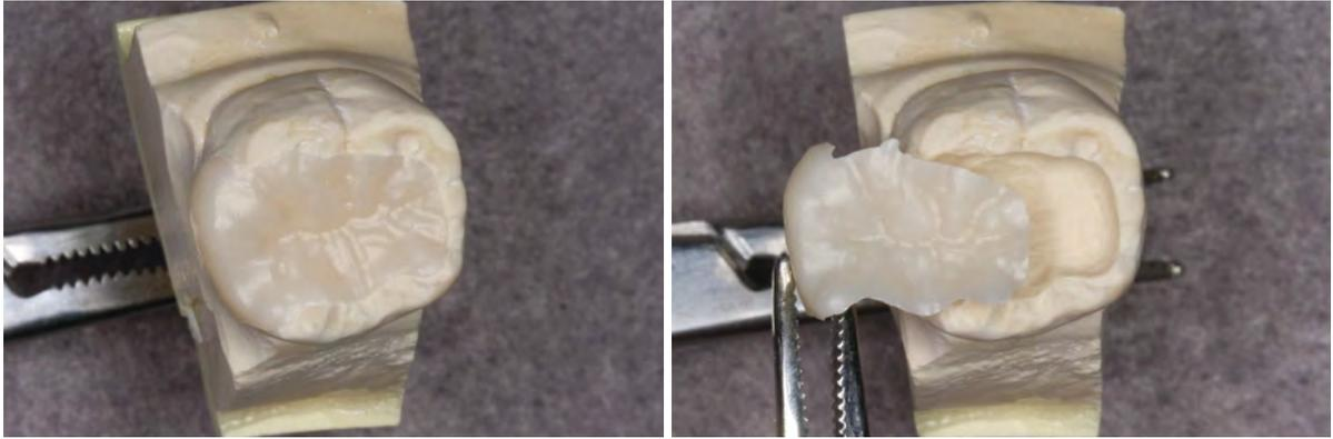
図 4, 5 無調整でほぼ適合しているモノリシックジルコニアインレー。適合させる方法はスキャン精度の向上（できるだけ精度の高いスキャナーを使用する）、CAD ソフトウェアの設定値の最適化、CAM ソフトウェアの加工パスをインレー用に最適化することが必要となる。加工時間は多少長くなってもチッピングせず、精密に加工したほうが生産性が向上すると考える。人の手で時間を掛ければ高精度の適合を得ることができるが、それでは CAD/CAM システムを使うメリットを活かせない
