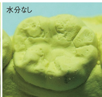
図2, 3 図2は図1の状態に注いだ石膏模型, 図3は図1の印象面からエアーで水を飛ばして注いだ石膏模型。2つで比較すると、「水分あり」(図2)のほうがぼやけていて、「水分なし」(図3)のほうがシャープに見えます 資料 10-1
