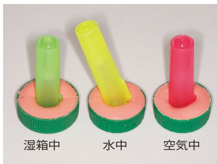
図2 保管条件を変えて1時間後に適合をチェック。水中に保管したものはアルジネートが膨張して、ペンキャップが戻りませんでした 資料 10-1
