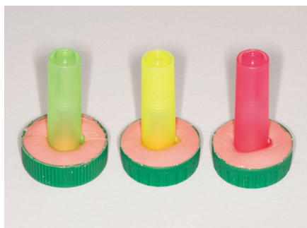
図1 アルジネート印象材の寸法変化を見る簡易実験。ペットボトルキャップでペンキャップを印象しました 資料 10-1
