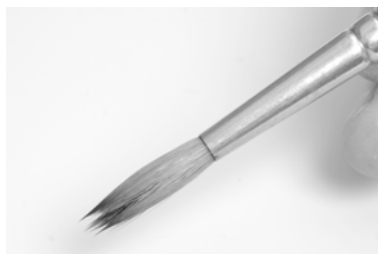
図 2-4 筆先が整っていないと、陶材が筆のなかに混入してしまい、適切な作業が困難となる
