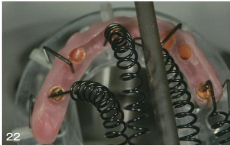
22 ドブルクロウネを固定装置に取り付け、先端が尖った陰極治具を電铸キャップ外冠の軸側面に接触させて通電できるようにする。中央の黒い棒は温度センサーである。電磁力線の影響で、陽極は円形のほうが電着効率が良く、より均一な電着（スローイングパワー）が可能になる
