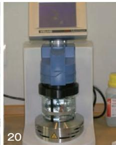
20 『AGC MicroVision』電铸装置。高速化を考慮して電着初期には低電流強度で開始し、徐々に高電流強度に移行し、ピークに達したら再度電流強度を低くして、終了前には電着初期の電流強度に戻るようプログラム制御され、硬度の向上と高速化を図っている。横断面では表裏は同じ性状であるが、中間層の内部は異なる性状と考えるとわかりやすい
