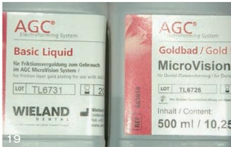
19 アバットメントサイズ（チャート板）から電着に必要な金電解液量を計量し、基本液でピーカー内に電解液で満たされるように液量を調整する。金電解液（Goldbad）を無駄なく使用するための配慮が見られる。Microに比較してGoldbadには光沢剤等がすべて含有されているので、添加剤や活性剤は付属していない
