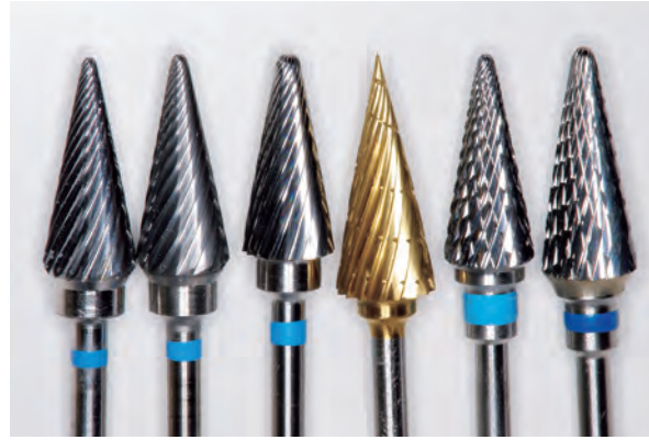
図14-5 三角錐カーバイドバーの種類。おもに咬合面の隆線をカービングするのに三角錐の形態が有用である。使いかたは、まず咬合面に小窩から付与し、そのくぼみに三角錐カーバイドバーの先端をあわせ、そこを支点にして放射状に隆線を形成する。このため、筆者が好んで使う三角錐カーバイドバーは左（JOTA/C416）である。左から2番目は似ているが微妙に先端が太い。左から4番目の金色のバーはチタンコーティングされているが、先が尖りすぎているため先端を支点にしにくく、放射状に隆線をカービングすることが困難である。右からの2本は刃がクロスカットされており、切削面が粗くなる。
