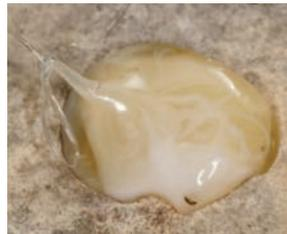
透明感の強い部分をピンセットでつまんで引っ張ってみると、元の押し湯とは全く違ったセラミックスに変化しています。
