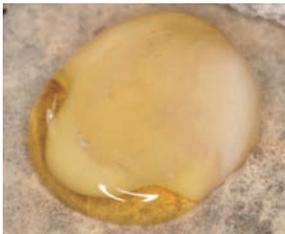
溶解状態で上から圧力をかけて変形させます。赤熱状態から温度が下がると、色調の変化によりセラミックスの変化がみとれます。
