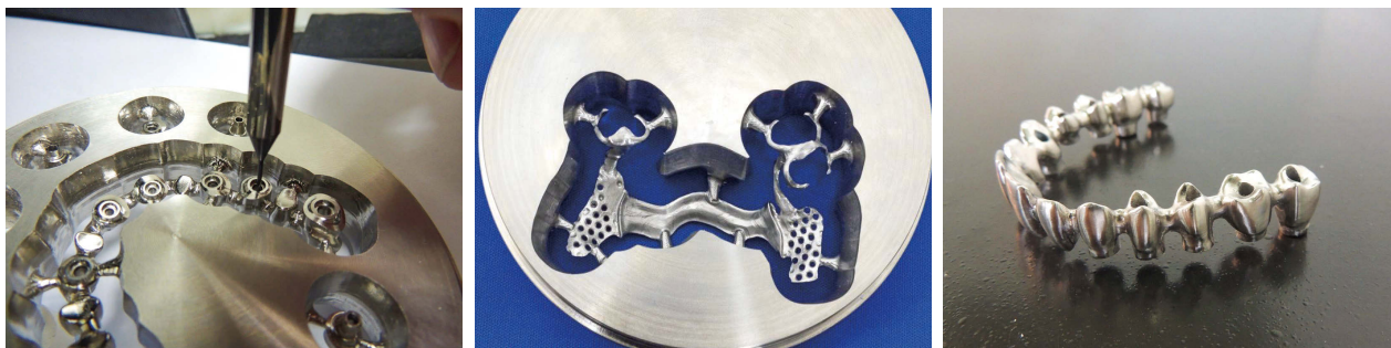
図1 CAD/CAM 切削加工用チタン合金ディスクとインプラント上部構造のフレーム
