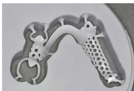
図10 レジンブロックから削り出された義歯フレームワークパターン
