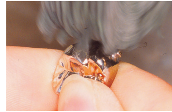
図 152 鹿革ホイールに酸化クロムなどを付け艶出し研磨
