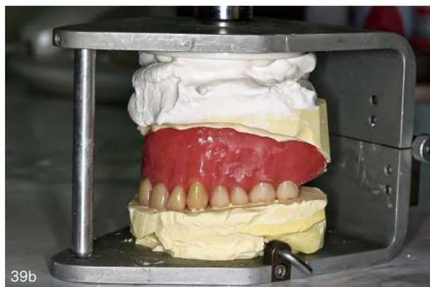
図 9-38, 39 義歯の着脱が可能な状態でジグにマウントしたいため、分離材としてティッシュコンディショナーの被膜を義歯内面に塗布した。リプレースメントジグにマウントされ咬合面コアが記録された治療用義歯
