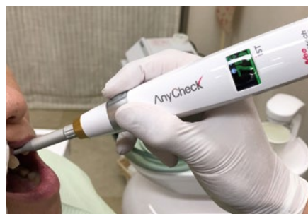
図01-25：IST値は75を示した。タッピングの位置はインプラントプラットフォームから上方7mmだったので、補正值に基づくると81になる。
