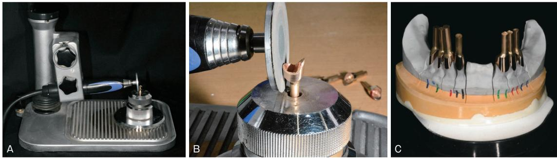
図9 KaVo K9 内冠研磨機による軸面研磨。
