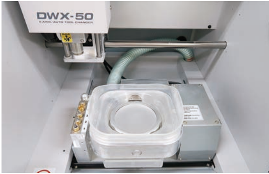
図1 5軸加工機 (DWX-50, Roland) 材料を360°回転させる軸と前後方向に20°傾ける軸を備えている。
