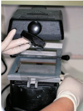
d: バキュームフォーマーにプラスチックシーネをセットする
