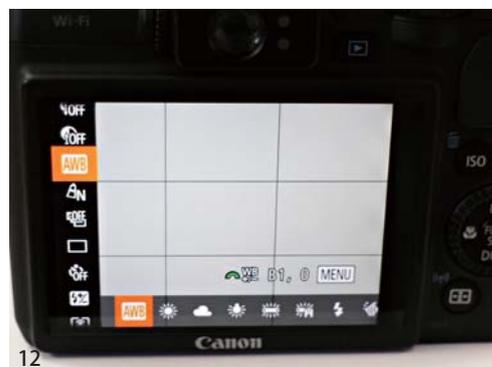
図 7~12 ここではマニュアルセッティング (M ダイヤル) の方法を紹介する. マニュアルセッティングではシャッタースピードや絞り値 (F 値), ホワイトバランス, 撮影モードなどを細かく設定できる. なお, カメラのノーマルレンズの先端にマクロレンズを装着するため, そのまま撮影してはマクロレンズの影まで写り込んでしまう (図 11). 撮影前にズーム操作を行い, 画面からマクロレンズの影がなくなったところが, マクロ撮影のレンズの基本ポジションとなる (図 12)
