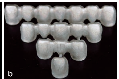
Fig.6-a ~ b 筆者が以前行った実験で使用した、ほぼ同形のメタルおよびジルコニアフレーム。両者の熱伝導の違いに有意差は認められたが、ジルコニアフレームは7本でも5g程度の重量であったため、本数による有意差は確認されなかった
