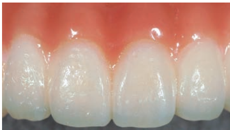
Fig.5 エナメル陶材の二次焼成後、内部ステインの焼成不足から、気泡が大量に発生した。薄く塗布するステインであれば通常の焼成スケジュールでも焼成が可能であるとの筆者の誤った思い込みが招いたものである
