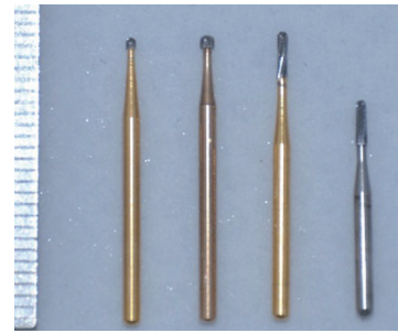
図 16-7 ポスト除去用カーバイドバー（左3本）。右端は通常のカーバイドバー。目盛は1mm
