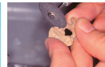
図 89 手指で複数のレストを設け、スプルーを慎重に切断する。
