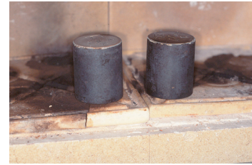
図 87 昇温中の casting リング。ワックスが焼却され埋没材と周囲が黒変している。
