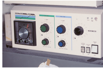
図 86 温度と昇温速度を設定できる電気炉
