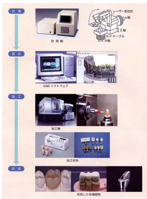
■図 18-27 CAD/CAM システムによる作製手順
